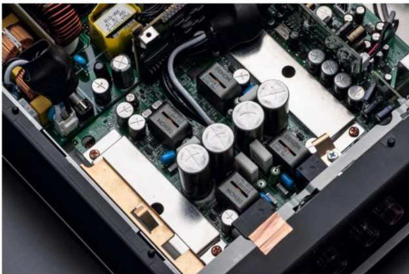
Im Vergleich zu ihren analogen Pendanten kommt die Digital-Endstufe des PMA-150H mit sehr wenig Platz aus. Für die Leistung von 2x70 Watt sind Power-MOS-FETs verantwortlich, die unter den kleinen Kühlblechen sitzen. Der winzige Qualcomm-Chip wird durch das Kabel zwischen den Spulen verdeckt.
