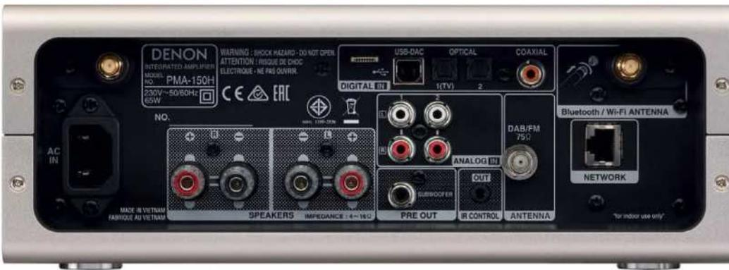
Die Anschlüsse des PMA-150H umfassen analoge und digitale Eingänge, Letztere auch per USB. Damit ist der PC-Anschluss möglich. Neben LAN finden sich Antennenbuchsen für DAB/FM und Bluetooth/WiFi.
