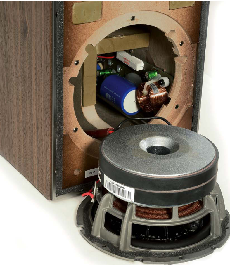
Der 17er Bass muss keine Vergleiche mit PA-Chassis scheuen. Massive Polkernbohrung und vollständige Belüftung der Schwingspule von vorne und hinten sorgen für hohe Dynamikreserven.
