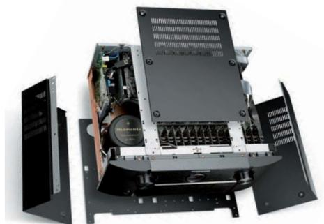
Der Deckel der AV8805-Vorstufe besteht aus drei Teilen. Das robuste Gehäuse wurde zur besseren Abschirmung mit Kupfer veredelt.
