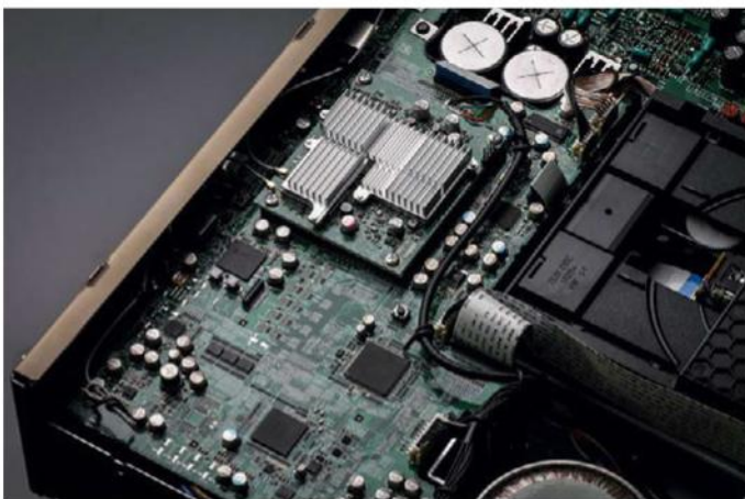
Das Digital-Board nimmt digitale Signale bis 384 kHz/32 Bit und DSD 11,2 MHz über USB-B an, mehr braucht wirklich kein Mensch. Kleine Kühlkörper (Mitte) sorgen für Wärmeableitung.
