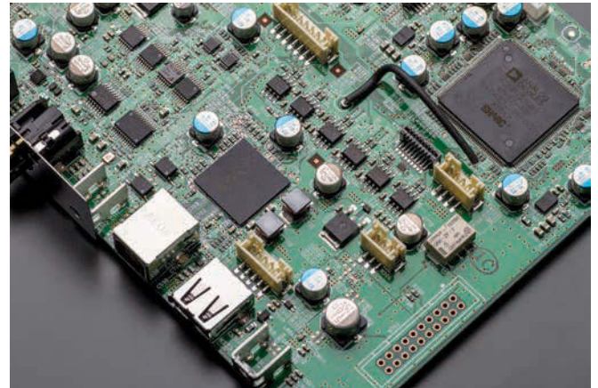
▲ Die DAC-Platine birgt die Marantz Musical Mastering Stream- und Conversion-Prozesse, also DSD-Upsampling und Analog-Rekonstruktion.
