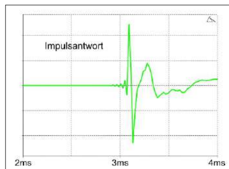
Die Impulsantwort ist guter Durchschnitt, Gehäuseresonanzen sind nicht zu erkennen.
