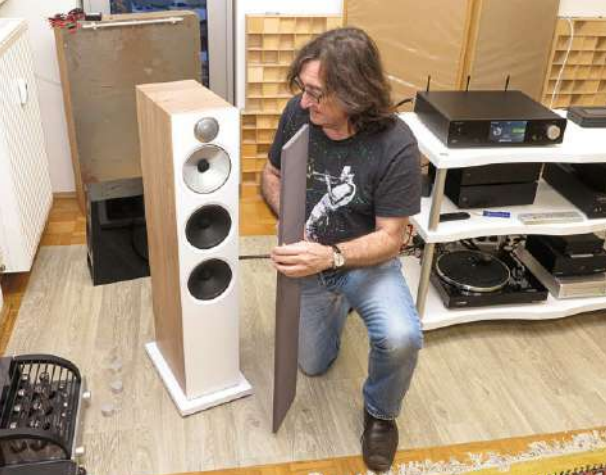
Die magnetisch haftende Bespannung ist farblich abgesetzt und haftet gut.
