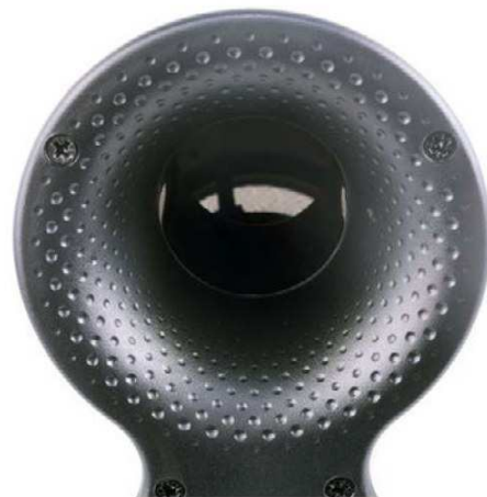
Der Flowport genannte Bassreflex ist sehr stabil ausgeführt und geht in das Terminal über. Seine Oberfläche soll hörbare Strömungsgeräusche unterbinden. Er sorgt für eine Anhebung des Pegels bei 60 Hz.
