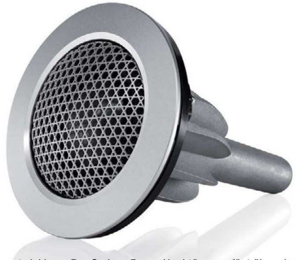
Neuentwicklung: Der Carbon-Dome-Hochtöner verfügt über eine mit Kohlenstoff beschichtete Alukalotte (daher die dunkle Färbung), die von einem 0,3 mm starken Kohlefaserring versteift wird. Sie soll der Diamantkalotte klanglich recht nahe kommen.
