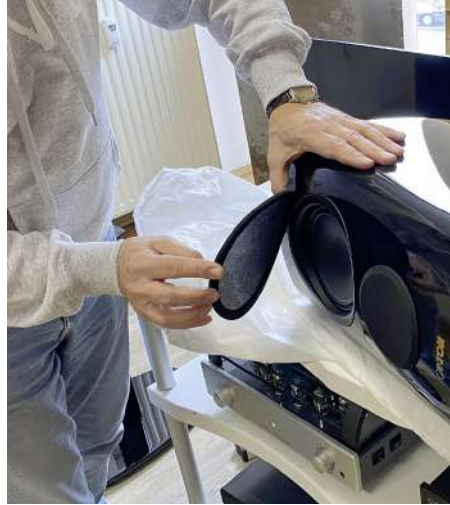
Jedes Chassis der Reference 9 hat eine eigene, unsymmetrische und magnetisch haftende Abdeckung.
