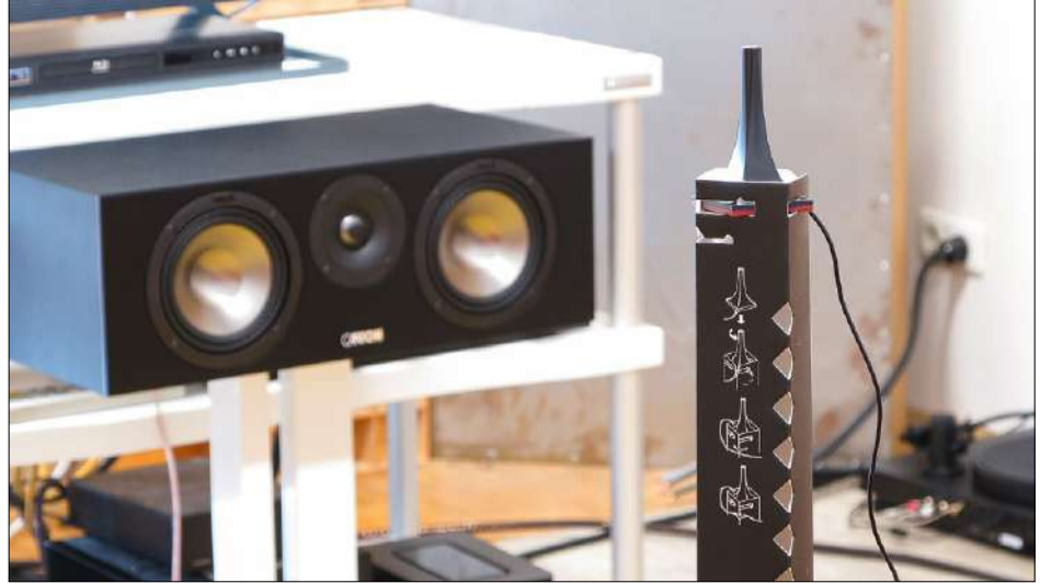
Denon liefert mit dem Receiver einen praktischen Papp-Aufsteller für das Einmess-Mikrofon. Sehr durchdacht hebt dieser das Mikrofon auf die korrekte Höhe und stabilisiert es während der Messung.
