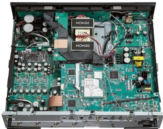
**Ordentliches Netzteil mit separatem Analogzweig, Topwandler in Vierfach-Konfiguration, diskrete Ausgangsstufe: Denon kann's!**
