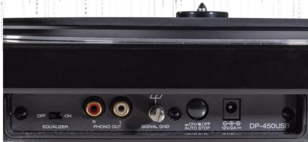
Auf der Rückseite aktivieren und deaktivieren wir die Endabschaltung und den internen Phonorverstärker. Dieser heißt hier allerdings Equalizer
