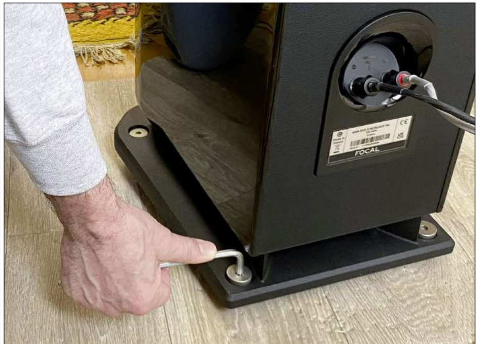
Die massive Aluminium-Bodenplatte der Aria erhöht die Standfestigkeit und nimmt die höhenverstellbaren Spikes auf. Statt des mitgelieferten Plastikwerkzeugs nahmen wir Stahl zur Hand.
