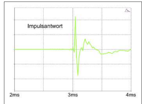
Das von der Sprungantwort erfasste Timing ist für eine Mehrwege-Box gut.
