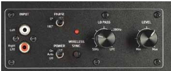
Die Ausstattung des Focal ist aufs Sinnvolle beschränkt: In der Praxis genügen auch Trennfrequenz-, Pegelregler und Phasenschalter zur optimalen Anpassung. Der Taster synchronisiert den Sender.
