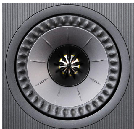
Die Coda W hat den 13er-Uni-Q-Koaxialtreiber neuester, 12. Generation verbaut.
