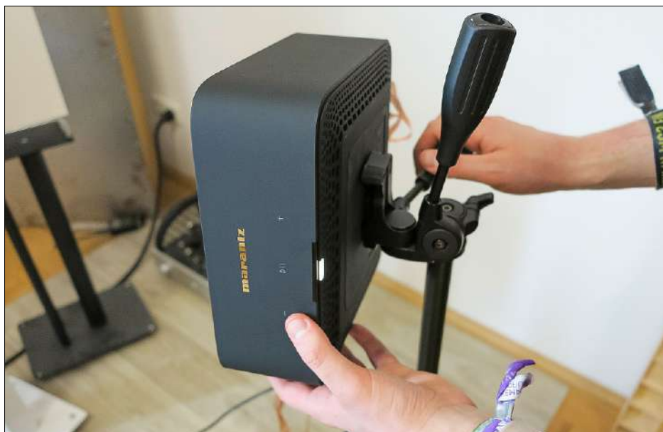
An der Unterseite des Marantz-Streaming-Amps ist ein Schraubgewinde angebracht - damit kann er etwa an eine Wand geschraubt werden, zur Demonstration hier auf einem Stativ.
