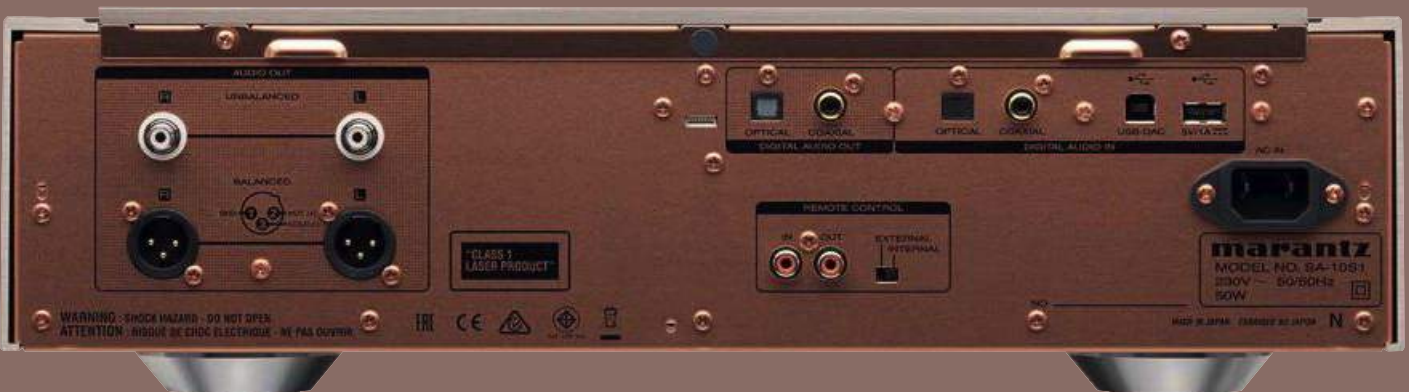
Gut zu erkennen: Die stabilen Seitenteile sowie das dicke Dach des Gehäuses. Der SA-10 bietet Digitaleingänge einschließlich USB-A und -B. Für den unwahrscheinlichen Fall, dass Sie einen klanglich überlegenen D/A-Wandler haben, gibt es auch digitale Ausgänge.
