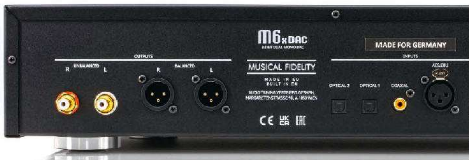
Die Analogausgänge des M6x liegen sowohl asymmetrisch (RCA) als auch symmetrisch (XLR) vor. Die Digitaleingänge akzeptieren PCM- und MQA-Datenströme bis zu 24/192.
